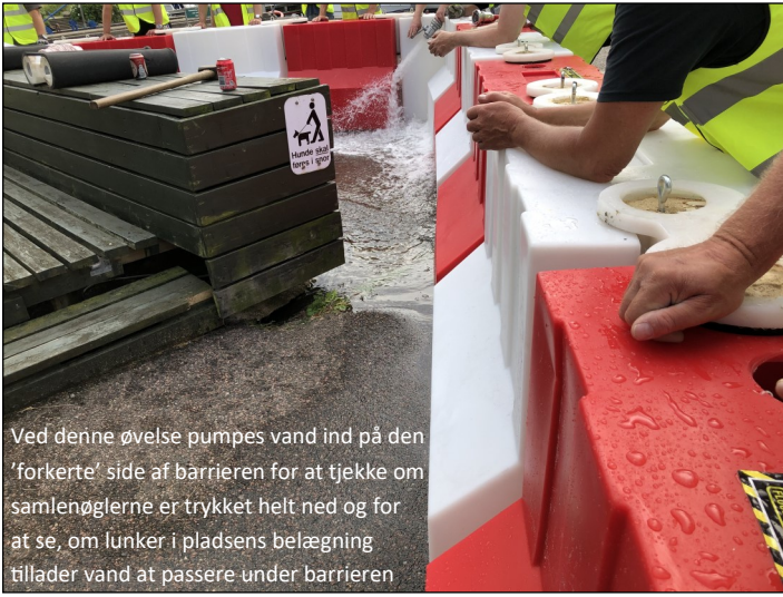
De hvide elementer fylder sig selv med vand fra oversvømmelsen
